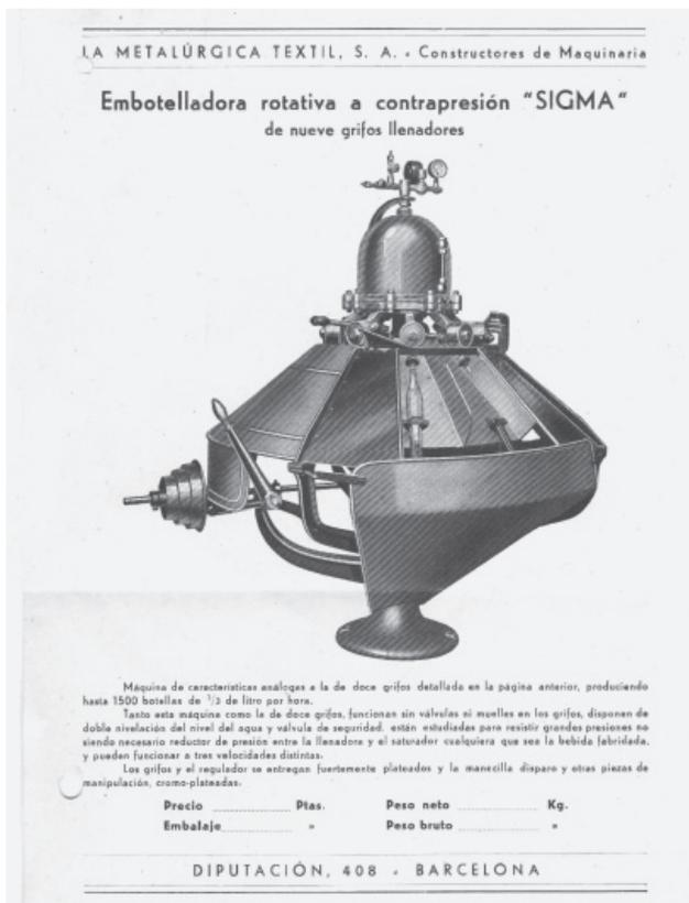
FIGURA 25: Folleto de embotelladora rotativa a contrapresión "SIGMA" de nueve cabezales, máquina adquirida por Amorós-Isábal en los años 40
