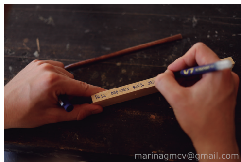
Fig. 2: Anotación de información clave en el listón. Podemos ver el código del testigo «PH12» que hace referencia a la especie (PH ->Pinus halepensis) y al número de árbol (12), el diámetro (DAP) medido en centímetros, la parcela a la que pertenece el testigo (BIN1 -> Binéfar-1) y la fecha de extracción del testigo (23/12/2022) (Foto: Marina García Moreno-Cid)
