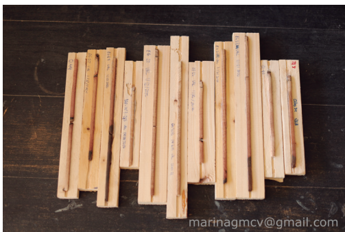
Fig. 6: Testigos tras la fase de procesamiento (Foto: Marina García Moreno-Cid)
