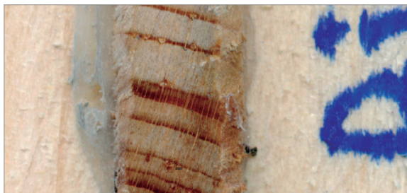
Fig. 7: Muestra dendrocronológica analizada en Coorecorder 7.6 (Cybis) (Foto: Marina García Moreno-Cid)
