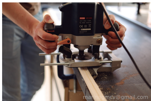
Fig. 1: Fresadora haciendo surco en un listón que posteriormente se usará en análisis dendrocronológico (Foto: Marina García Moreno-Cid)
